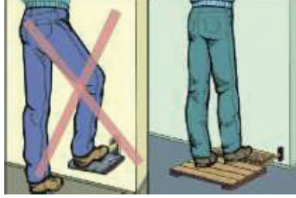
Görsel 1.27: Pedal kullanarak yapılan çalışmalarda yanlış ve doğru ergonomik tasarımlar
